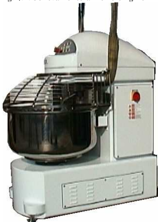
Fig. 4.1: Sollevamento a mezzo cinghie
